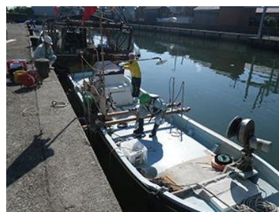
測量船艀装状況
