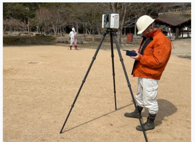
地上レーザー測量 観測状況
